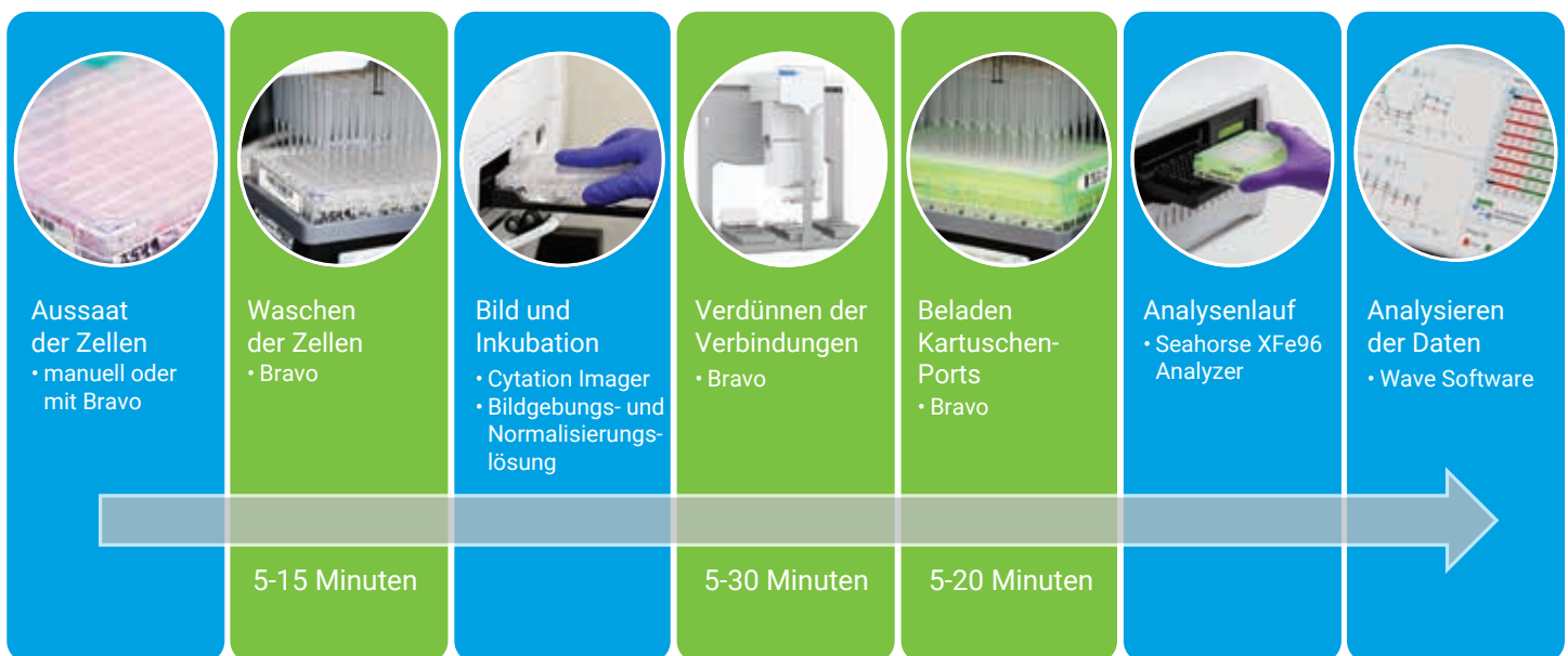
Abbildung 5: Allgemeiner Arbeitsablauf einer Seahorse XF Analyse. Die Probenvorbereitungsschritte, die mit der Bravo Plattform automatisiert wurden, sind grün dargestellt: Zellwaschung, Herstellung der Injektionslösungen und Beladung der Seahorse XFe96 Sensorkartuschen. Die insgesamt gesparte praktische Arbeitszeit betrug 20 bis 60 Minuten pro Platte.
