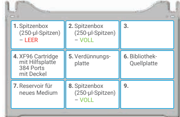
Abbildung 4: Bravo Deck Konfiguration und die für die Verdünnungsserie verwendeten Laborgeräte.
